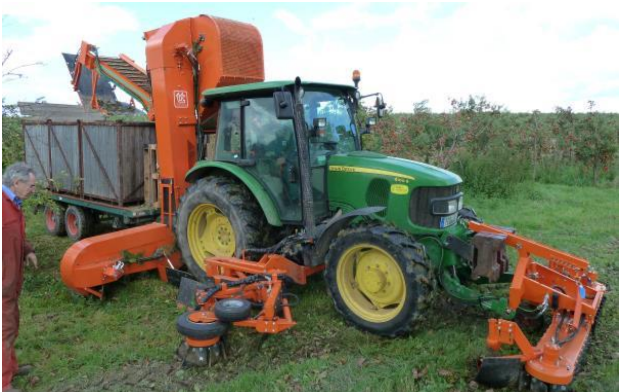
Deze machine raapt het afgefallen fruit op. De opgeraapte appels worden in een kieper gestort.
