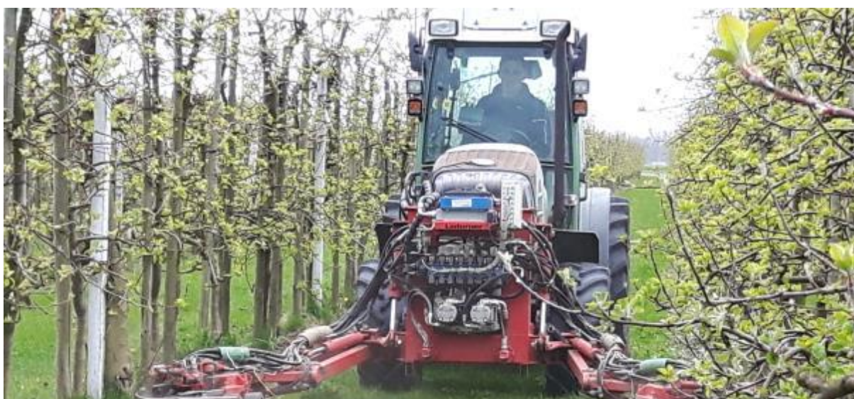
De Ladurner wordt zeer vaak ingezet voor mechanische onkruidbeheersing.
